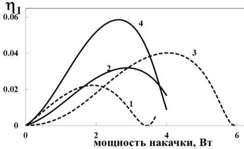
Рисунок 5. Зависимость эффективности преобразования в сигнальную волну от мощности накачки для  $I_{1\ell} = 0$  при  $I_{20}/I_{30} = 0.1$  (кривые 1-3) и 0.2 (кривая 4) и  $\Delta = 5 \text{ см}^{-1}$  (кривая 3),  $5.5 \text{ см}^{-1}$  (кривые 2 и 4)  $6 \text{ см}^{-1}$  (кривая 3).
