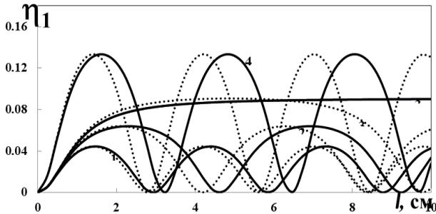
Рисунок 4. Зависимость эффективности преобразования в сигнальную волну от полной длины метаматериала  $\ell$ , полученные в ПЗИ, для  $I_{1\ell}=0$ ,  $\Gamma_3=1 \text{ см}^{-1}$  при  $\Delta=3 \text{ см}^{-1}$  (сплошные кривые 1 и 4),  $2.5 \text{ см}^{-1}$  (сплошная кривая 2) и  $2.097688 \text{ см}^{-1}$  (сплошная кривая 3),  $I_{20}/I_{30}=0.1$  (сплошные кривые 1-3) и  $0.3$  (сплошная кривая 4). Результаты, полученные в ПЗП даны точечными кривыми.
