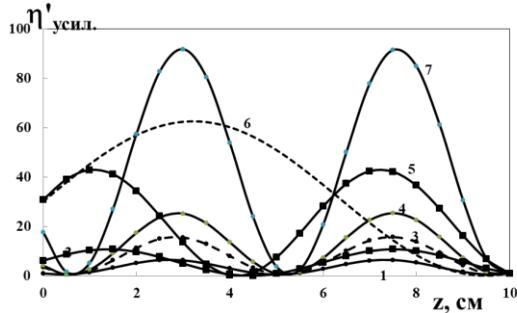
Рисунок 6. Зависимости коэффициента усиления, от длины метаматериала для  $\Gamma_3=1 \text{ см}^{-1}$ ,  $\ell=10 \text{ см}$ ,  $\Delta=2.5 \text{ см}^{-1}$  при  $I_{20}/I_{30}=0.1$  (кривые 1, 3, 4 и 6), 0.3 (кривые 2 и 5) и 0.5 (кривая 7),  $I_{20}/I_{1\ell}=1$  (кривая 1), 5 (кривая 3), 10 (кривые 2 и 4), 50 (кривые 5, 6 и 7)
