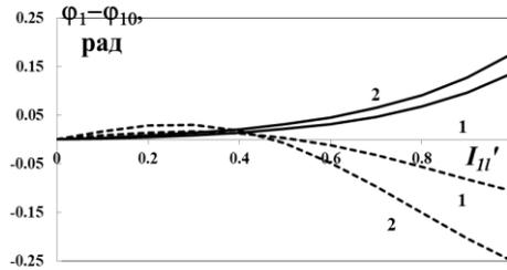
Рисунок 2. Зависимости изменения фазы волны накачки от интенсивности основного излучения в метаматериале (сплошные кривые 1 и 2) и в обычной среде (пунктирные кривые 1 и 2) при  $\Gamma\ell = 1$  для двух значений приведенной фазовой расстройки  $\Delta=0.5$  (сплошные кривые 1) и 1 (сплошные и пунктирные кривые 2).
