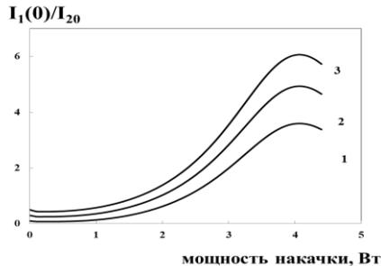
Рисунок 8. Зависимость эффективности преобразования в сигнальную волну от мощности накачки для полной длины метаматериала  $\ell = 2$  см,  $\Delta\ell/2 = 2.6$  при  $I_{1\ell} / I_{20} = 0.1$  (кривая 1), 0.3 (кривая 2) и 0.5 (кривая 3).
