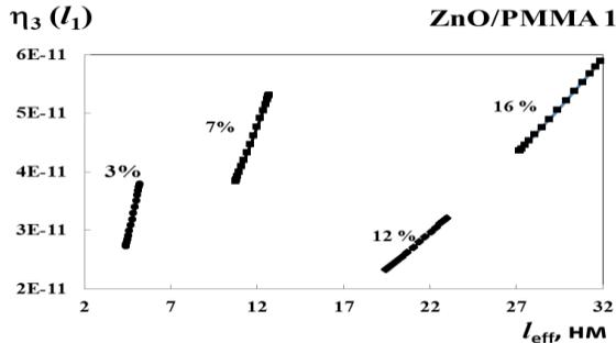
Рисунок 3. Зависимости эффективности преобразования волны накачки в волну третьей гармоники от эффективной длины при интенсивности накачки  $20 \text{ ГВт/см}^2$  для  $\delta_3=3\delta_I=0.06 \cdot 10^4 \text{ см}^{-1}$  (кривые 1 и 3),  $0.076 \cdot 10^4 \text{ см}^{-1}$  (кривые 2 и 4) и  $0.13 \cdot 10^4 \text{ см}^{-1}$  (кривые 5 и 6).
