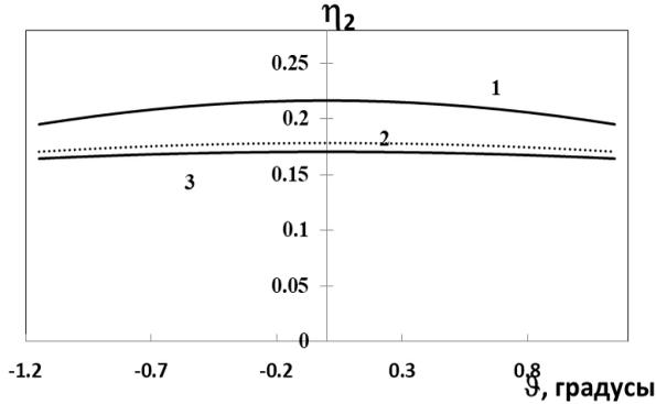
Рисунок 10. Зависимость эффективности преобразования второй гармоники в кристалле  $\text{AgGa}(\text{Se}_{1-x}\text{S}_x)_2$  от фазовой расстройки, при  $\delta_{1,2}=0.1 \text{ см}^{-1}$ ,  $I_{10}= 1.5 \text{ мВт/см}^2$ , длине кристалла  $l=0.2 \text{ см}$  для трех значений параметра  $x=0$  (кривая 3), 0.2 (кривая 2) и 1 (кривая 1).
